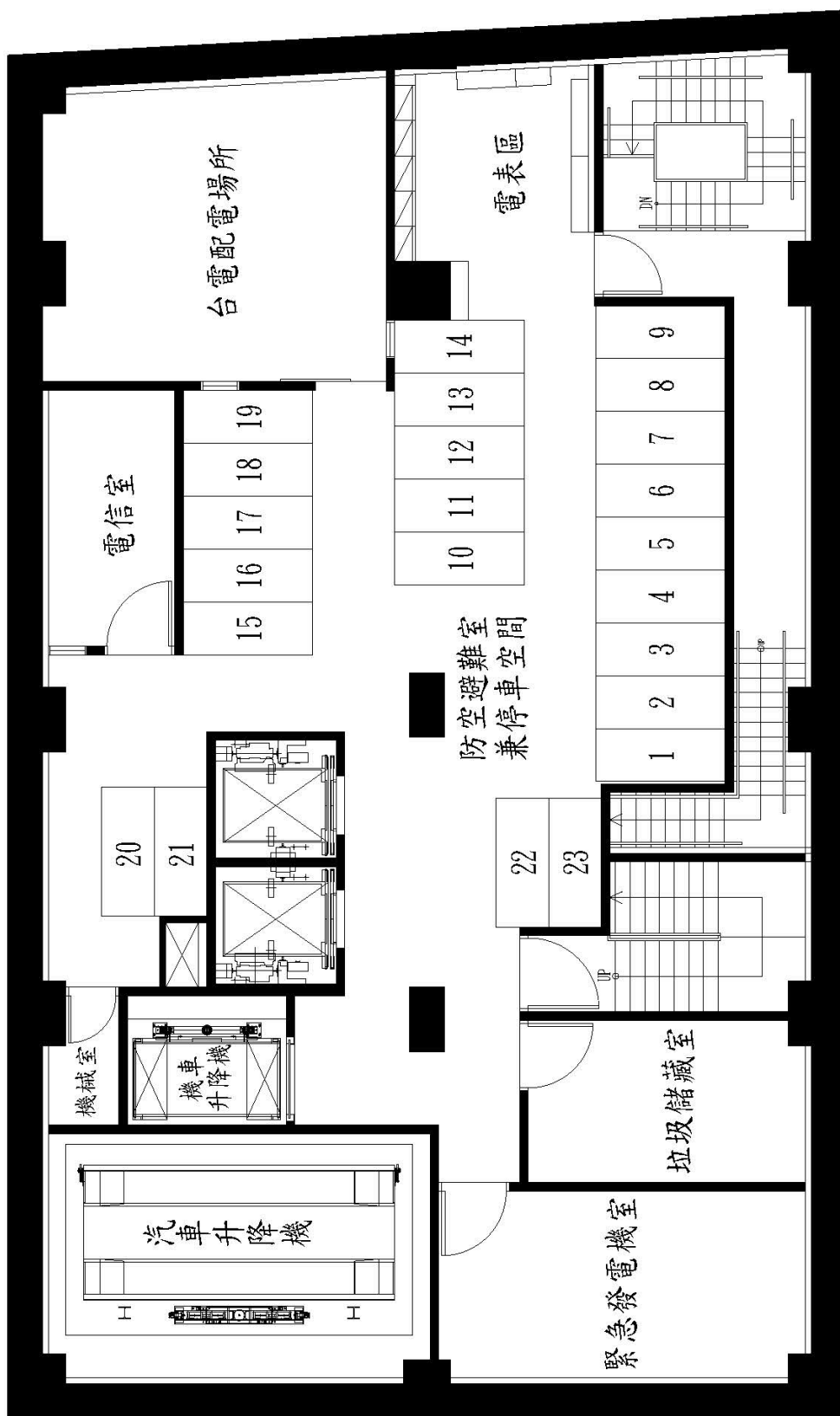
附圖二：汽車停車空間平面圖—地下一層
